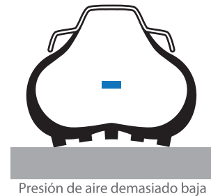
Presión de aire demasiado baja
